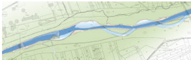
Lageplan der Umgestaltungsstrecke mit altem Gewässerlauf (dunkelblau) und angelegten Laufverschwenkungen (hellblau)
